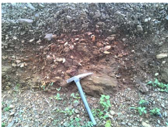
Foto 13 e 14: – Neossolo litólico e fraturas preenchidas com material argiloso na área do reservatório.
