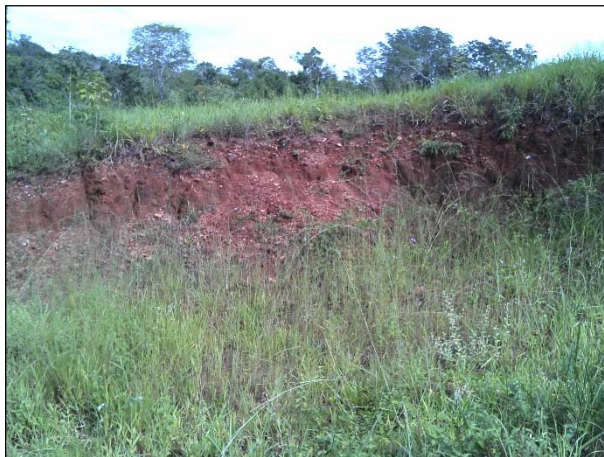
Foto 2: Cascalho quartzoso em matriz argilo arenosa, na área do reservatório.
