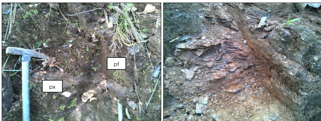
Foto 6 e 7: As feições estruturais no maciço rochoso xistoso, plano de fratura (pf) interceptando a xistosidade (px).
