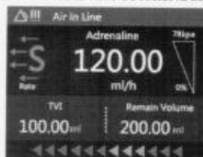
Figura 6-5 Alarme de ar na linha
