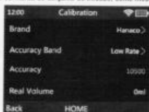
Figura 10-1 Calibração para precisão do conjunto de infusão
