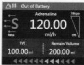
Figura 8-6 Alarme de falta de bateria
