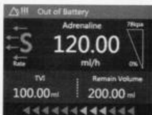
Figura 18-6 Alarme de falta de bateria
