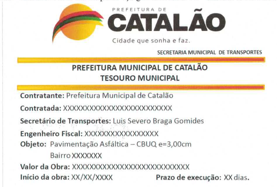
Figura 01 – Modelo: Placa em chapa de aço galvanizada nº 24 - Pintada em esmalte sintético
