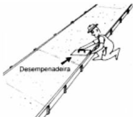
Figura 4 - Método de acabamento da calçada
