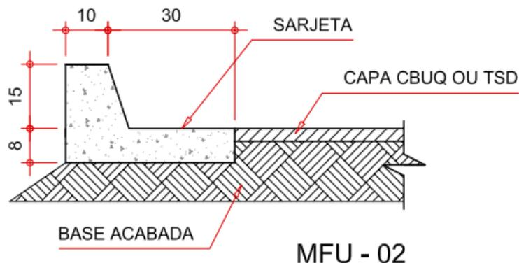
Os meios-fios deverão ser executados mediante ao emprego de fôrmas metálicas deslizantes, acopladas a máquinas automotrizes adequadas à moldagem do concreto na execução dos mesmos, por extrusão. Em qualquer dos casos o processo executivo
