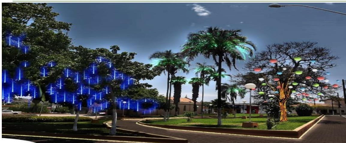
**4.6.5. CORDÃO DE LED COR BRANCA NAS VEGETAÇÕES:** Deverão ser instaladas nas vegetações ornamentais existentes cordão de microlâmpada com reprodução de cor branca, 100 LEDs, fixos, com fiação na cor transparente, comprimento total mínimo de 10m, tensão 220V e consumo máximo total de 6W, conforme ilustra a figura a seguir.
